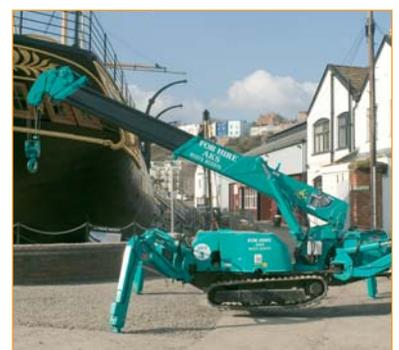
Die Lasttabellen für die Nutzlast insgesamt wurden auf der Grundlage des tatsächlichen Arbeitsradius einschließlich der Mastdurchbiegung des Auslegers ermittelt. Das Hakengewicht (standardmäßig 4-fach - 20kg) muss als Teil der in diesen Nutzlasttabellen aufgeführten Last mit berücksichtigt werden.
