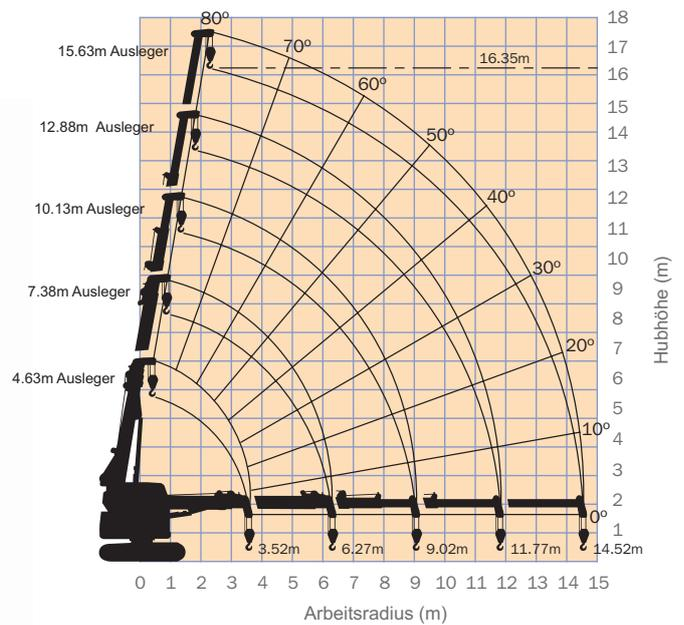
Das Arbeitsdiagramm berücksichtigt nicht die Mastdurchbiegung des Auslegers unter Last.
